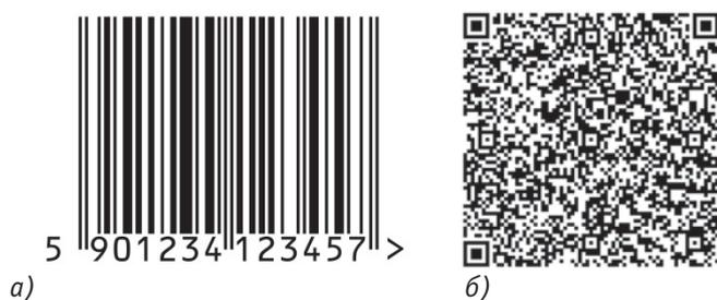
Рис. 1. Маркировка штрихкодом: а) линейный штрихкод; б) двумерный штрихкод
