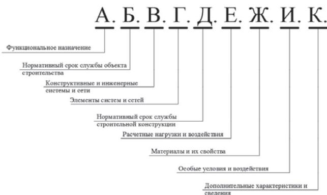
Рис. 2. Схема кодирования элемента информационной системы
