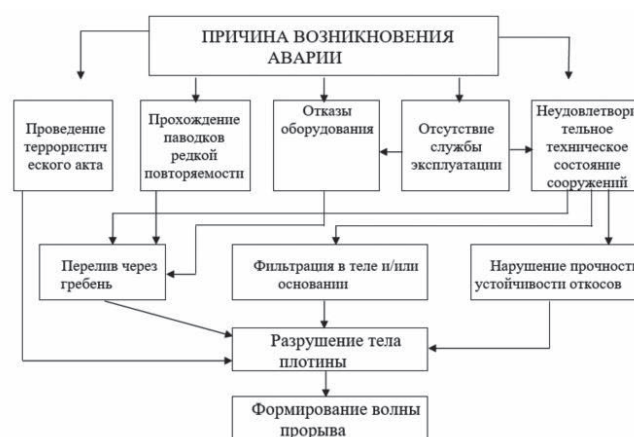
Рис. 1. Блок-схема анализа вероятных сценариев возникновения и развития аварии на гидроузле с грунтовой плотиной. Схема авторов статьи
