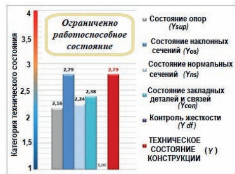
Рис. 7. Графическое отображение итоговых результатов определения принадлежности контролируемых групп параметров к категориям технического состояния. Диаграмма авторов статьи
