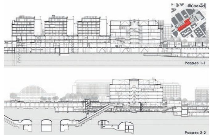
Рис. 7. Квартал «Камппи» (Kamppi), Хельсинки: разрез 1–1 по жилым корпусам, разрез 2–2 по площади и станции метро (источник: <https://finnisharchitecture.fi/kamppi-shopping-centre-and-public-transport-terminal/>)
