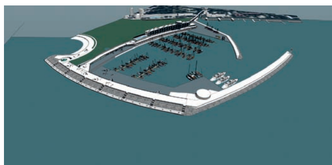
Рис. 12. Схема развития набережной и компоновочные решения берегозащитных и оградительных гидротехнических сооружений (источник: ООО АБ «ГОР-ПРОЕКТ». Сочи. 2021 год)
