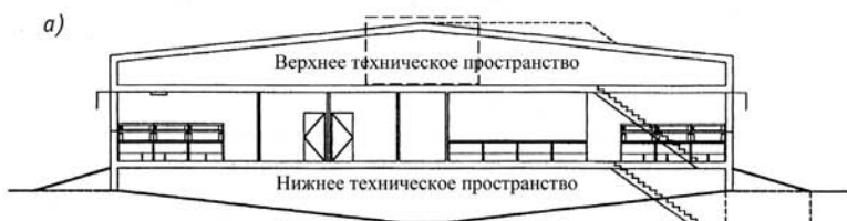
а) б) Рис. 10. Примеры группировки коммуникаций во внутренних ядрах здания: а) индустриальный отель «Берлие». Париж. Архитектор Доменик Перро (источники: [11, с. 329; 27]); б) научно-производственный отель «Метрополь 19». Париж. Архитекторы Жан-Поль Вигер и Жан-Франсуа Жодри (источники: [11, с. 330; 28])
