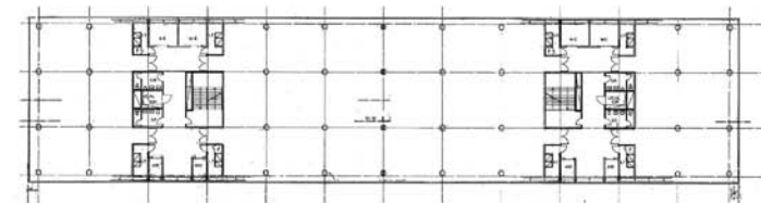
а) б) Рис. 10. Примеры группировки коммуникаций во внутренних ядрах здания: а) индустриальный отель «Берлие». Париж. Архитектор Доменик Перро (источники: [11, с. 329; 27]); б) научно-производственный отель «Метрополь 19». Париж. Архитекторы Жан-Поль Вигер и Жан-Франсуа Жодри (источники: [11, с. 330; 28])
