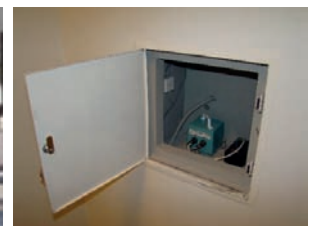
а) общая схема расстановки; б) общий вид измерительного пункта с акселерометрами ЦТА-СМ на конструкциях покрытия; в) размещение регистрирующих приборов в измерительном пункте
