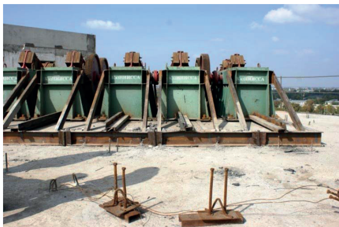
Рис. 2. Испытание крупнопанельного девятиэтажного дома в Узбекистане с помощью вибромашин инерционного действия типа В-3, установленной на покрытии здания (источник: http://tvosibgtv.ru/events_geotechnics/vibrodinamicheskie-ispytaniya-9-ehnazhnogo-doma-v-uzbekistane.html )
