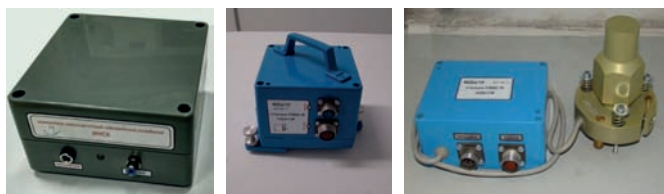
а) цифровой трёхкоординатный акселерометр ИНСК (измеритель низкочастотных сейсмических колебаний); б) цифровой трёхкоординатный сейсмометр ПРДП-СМ; в) цифровой двухкоординатный наклонометр ЦНД-СМ
