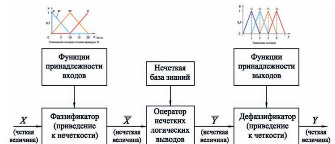
Рис. 3. Алгоритм нечёткого логического вывода Э. Мамдани. Схема автора статьи
