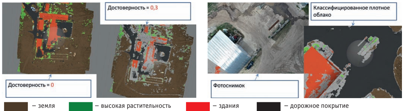
Рис. 2. Автоматическая классификация точек: а) результаты с различным уровнем достоверности; б) сравнение с исходным снимком
