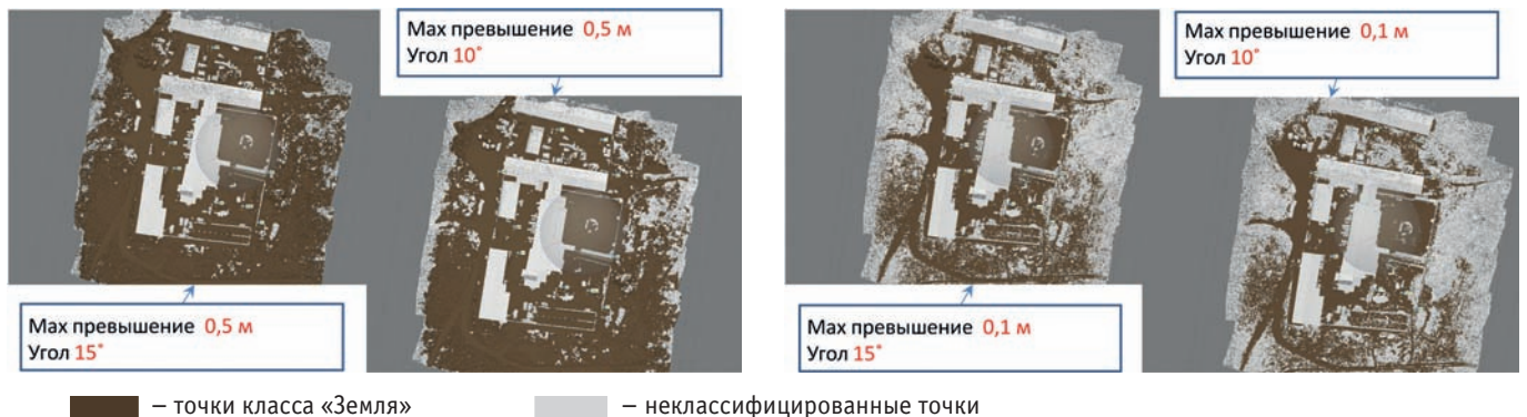
Рис. 1. Автоматическая классификация точек рельефа: а) результат с максимальным уровнем превышения 0,5 м; б) результат с максимальным уровнем превышения 0,1 м
