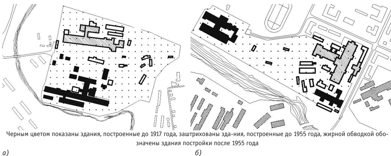
Рис. 10. Графоаналитические схемы на 1990 год текстильных предприятий Иванова, претерпевших внедрение корпусов 1920-х годов в историческую застройку промплощадок: а) фабрика «Красная Талка»; б) фабрика им. Ф.Э. Дзержинского. Схемы автора статьи
