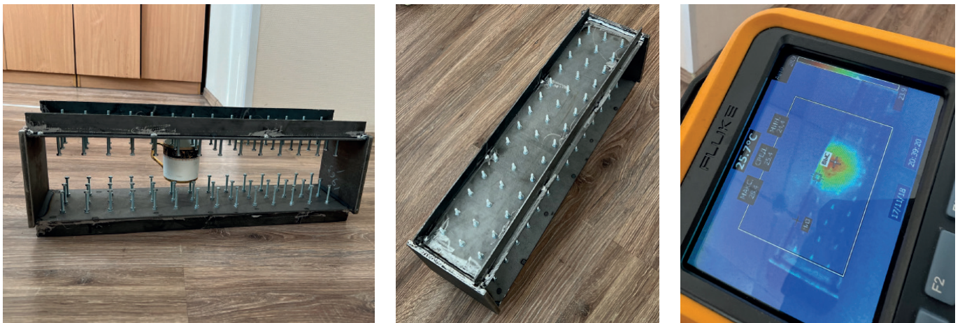
Рис. 3. Использование тепловизора для оценки нагрева фрагмента листовой опалубки с установленным внутри источником тепла. Фото авторов статьи
