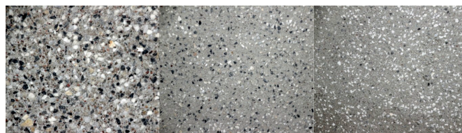
Рис. 2. Внешний вид терразитовой штукатурки при её обработке различным способом
