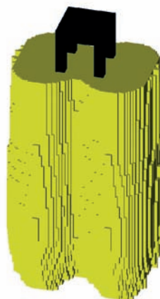
Рис. 6. Зоны намороженного грунта: а) через два холодные месяца; б) через четыре холодные месяца
