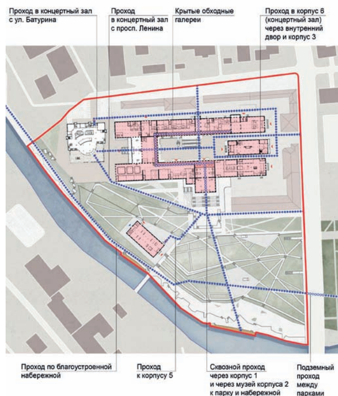
Рис. 3. Конгресс-центр на базе Большой Ивановской мануфактуры. Схема генплана. Проектное предложение. Красным цветом выделены исторические объекты. Авторы: А.С. Старикова, А.В. Шорошева. Руководители – проф. Е.Г. Трибельская, доц. Д.Д. Попова. МГАХИ им. В.И. Сурикова. 2023 год
