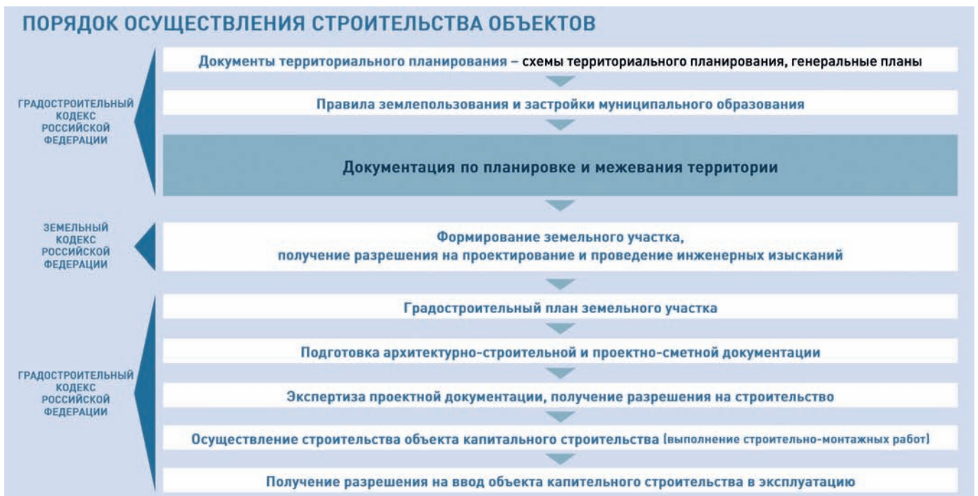
Рис. 3. Порядок осуществления строительства объектов. Схема составлена автором статьи на основе положений ГрК РФ
