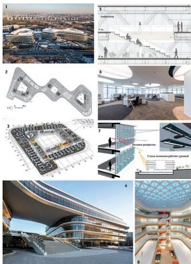
Рис. 3. Центр научных исследований и разработок «Хуавей». Нанкин: 1 – вид комплекса сверху; 2 – план четвёртого уровня; 3 – аксонометрическая схема рабочего модуля третьего уровня; 4 – вид застройки входной зоны и рабочего модуля; 5 – «облачный коридор» (фрагмент разреза); 6 – рабочие помещения; 7 – схема приёмов пассивного энергодизайна; 8 – центральный атриум рабочего модуля
