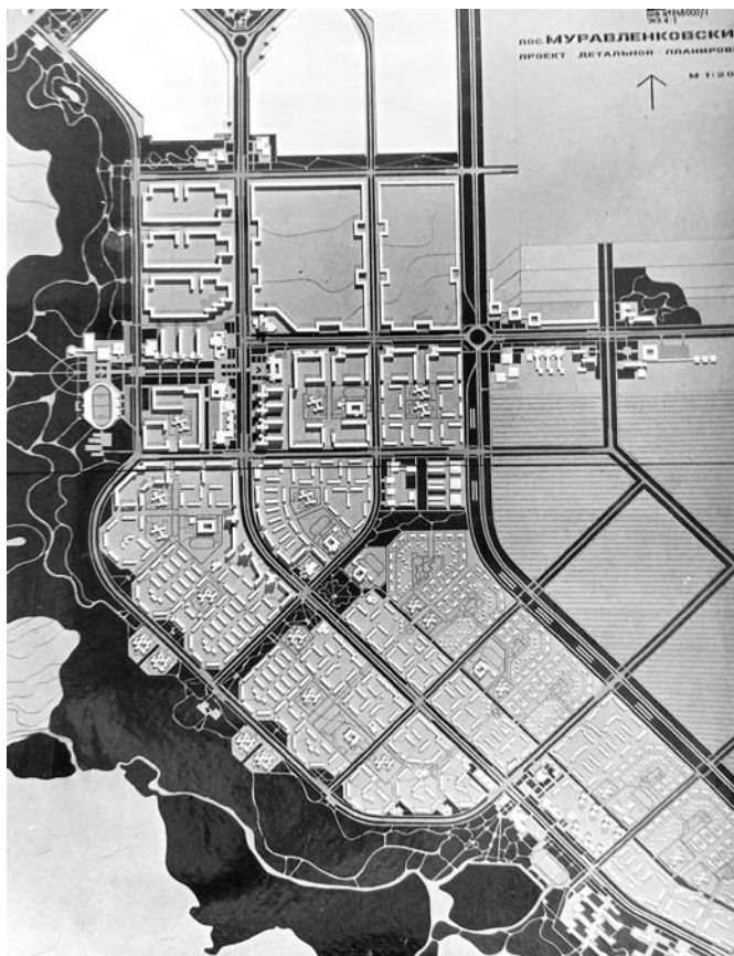
Рис. 2. Проект детальной планировки посёлка Муравленковский в соответствии с генеральным планом 1982 года (источник: Генеральный план посёлка Муравленковский // ГБУТО ГАТО. Ф. 1933. Оп. 6. Д. 234)
