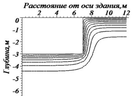
Рис. 4. Распределение изолиний концентрации радона в грунте в окрестности открытого котлована (рассчитано при значениях: h=3 м, d=7 м, шаг изолиний 5000 Бк/м 3 , =50 кБк/м 3 )
