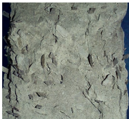
Рис. 1. Поверхность разрушенного фиброцементного образца, армированного аморфнометаллической фиброй
