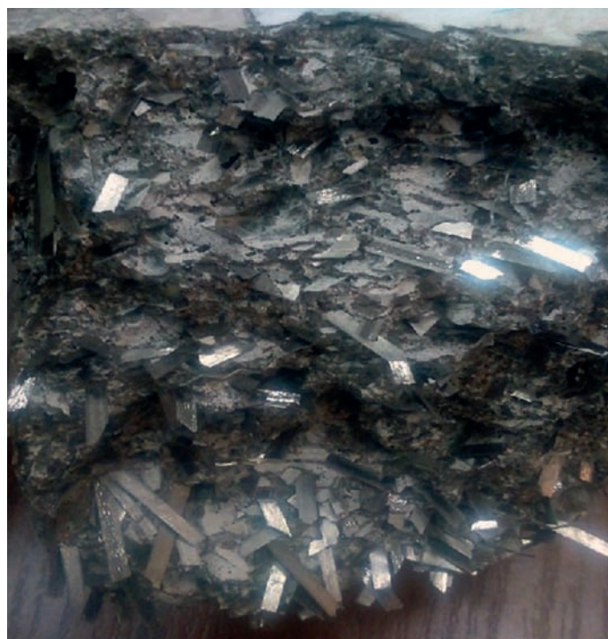
Рис. 4. Образец, армированный аморфнометаллической фиброй в количестве 3% по объёму, после испытания на изгиб
