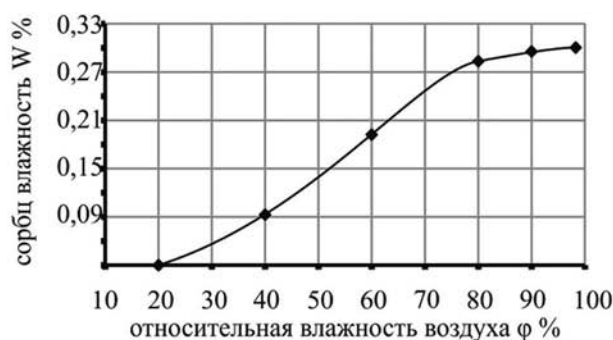
Рис. 3. Изотермы сорбции материалов при температуре 20 °С: ♦ – минеральная вата, × – силикатный кирпич, Δ – керамический кирпич, ◇ – ячеистый бетон
