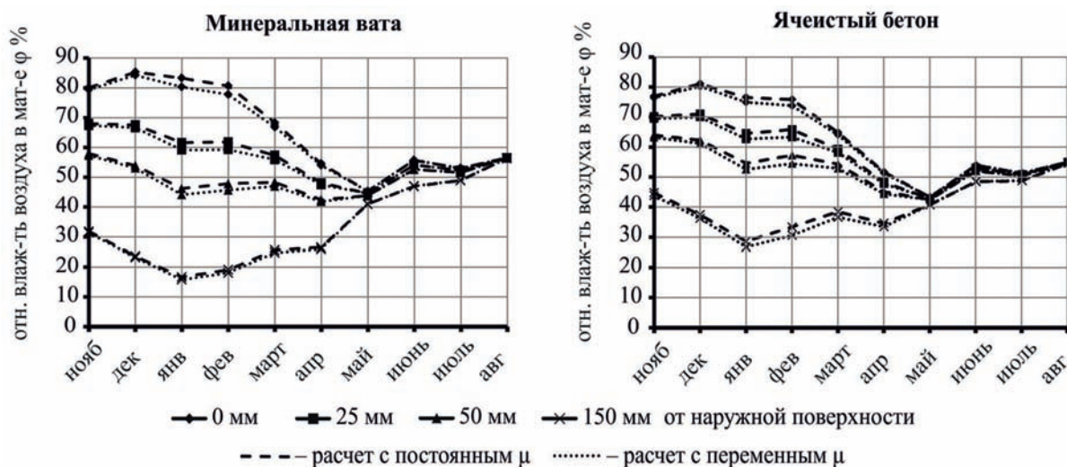
Рис. 6. Расчётные значения относительной влажности воздуха в сечениях теплоизоляционного материала ограждения с ноября по август
