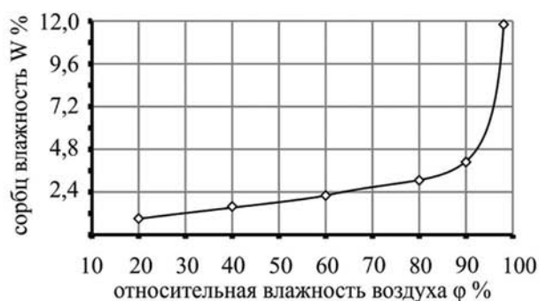
Рис. 3. Изотермы сорбции материалов при температуре 20 °С: ♦ – минеральная вата, × – силикатный кирпич, Δ – керамический кирпич, ◇ – ячеистый бетон
