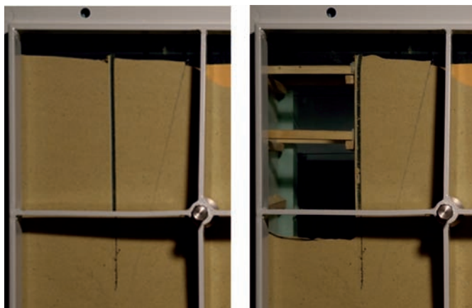
Рис. 2. Фотоснимки лабораторного опыта с наклонным геотехническим экраном: слева – до откопки котлована, справа – после откопки котлована
