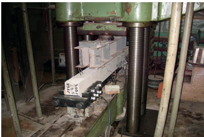
Рис. 7. Испытания железобетонной модели с внешним армированием композитным углепластиком
