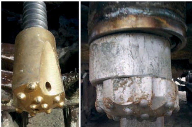
Рис. 7. Буровые долота для проходки скважин: слева – для анкеров типа «Титан», справа – для системы «Odex 115»
