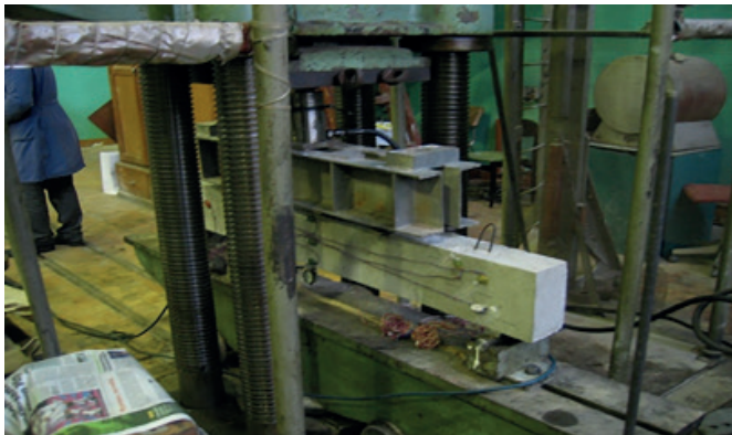
Рис. 6. Испытания железобетонной модели без предварительного напряжения
