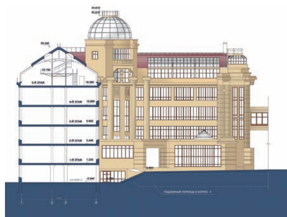
Разрез по южному крылу через Шуховский зал
