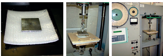
Рис. 3. Подготовка и проведение эксперимента по определению прочности сцепления (адгезии) металлической пластины к вспененному полиэтилену с клеевым слоем
