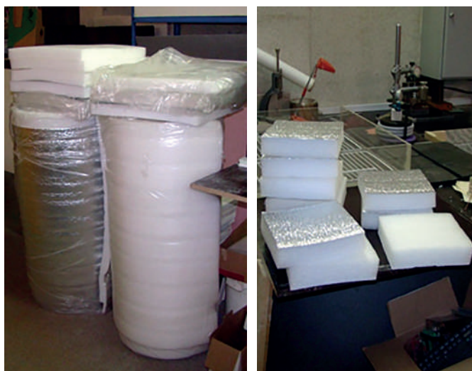
Рис. 1. Образцы теплоизоляционного материала из вспененного полиэтилена: рулоны и плиты с металлизированным покрытием и без него
