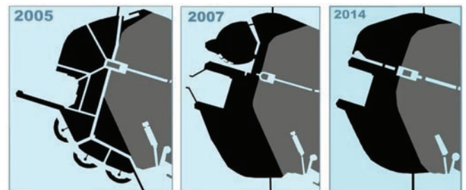
Рис. 5. Поэтапное уменьшение роли акватории в проектах намыва на Васильевском острове: слева – конкурсный вариант С. Гайковича и В. Линова, в центре и справа – принятые к реализации проекты
