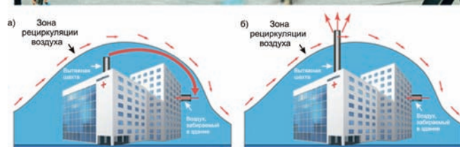
Рис. 6. Схема зон рециркуляции воздуха: а) заражённый воздух из вытяжной шахты может попасть в зону рециркуляции вокруг здания; б) чтобы избежать подобной ситуации, необходимо увеличить высоту вытяжной вентиляционной шахты (б) (источник: [3])
