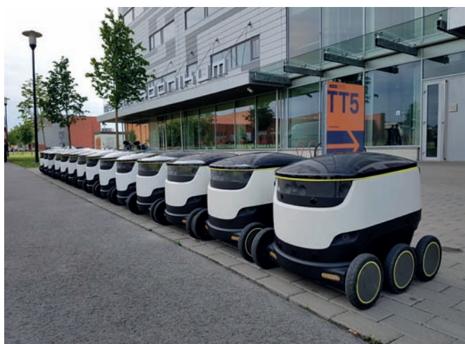
Рис. 13. Мобильные колёсные роботы для доставки товаров, заказанных через Интернет ( https://zen.yandex.ru/media/robroy/avtonomnyi-robot-dostavki-produktov-i-malogabaritnyh-vescei-5cd9a5a55bca0f00b018fa71 )
