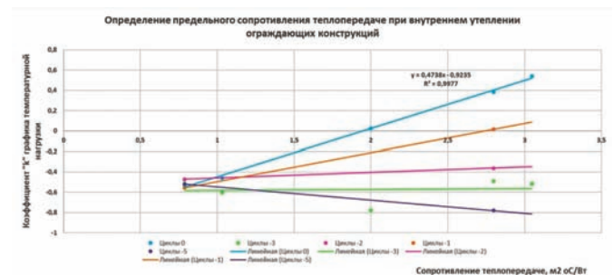
Рис. 8. Зависимость коэффициента k в линейном уравнении, характеризующем показатель температурной нагрузки, от сопротивления теплопередаче ограждающей конструкции с учётом разной температуры заморзания влаги в материале
