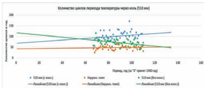
Рис. 7. Графики температурной нагрузки на материал ограждающей конструкции для наружной кирпичной стены 510 мм с и без утеплителя
