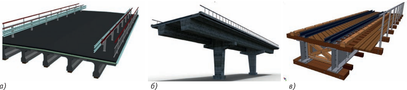
Рис. 2. Конструкции пролётных строений мостов: а) с применением сборных железобетонных элементов; б) с применением монолитных железобетонных элементов; в) составной мост.
