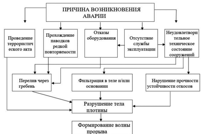
Рис. 1. Блок-схема анализа вероятных сценариев возникновения и развития аварии на гидроузле с грунтовой плотинной. Схема авторов статьи
