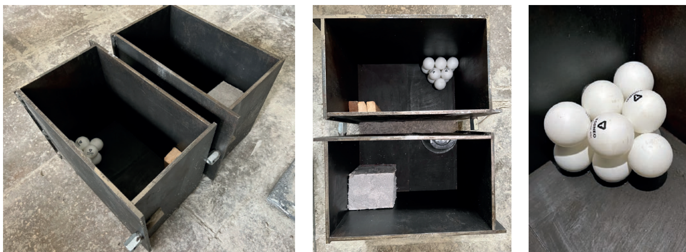
Рис. 4. Физическое моделирование дефектов в теле бетона образцов. Фото авторов статьи
