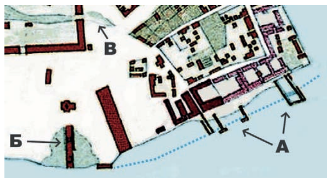
А – причальные мостки, Б – мощный проход сквозь заболоченный участок, В – канал с незакреплёнными бортами; ■■■ – предполагаемая граница мелководья
