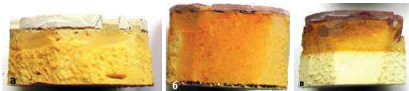
Рис. 5. Внешний вид ППУ слоя фасадной термopанели после воздействия УФ излучения (607 часов 30 минут) (x3): а) с клинкерной плиткой производства фирмы «ADW Klinker» коллекции «Beige Rustic Besandet»; б) с клинкерной плиткой производства фирмы «Houson» коллекции DS62901; в) с полимерпесчаной плиткой производства ООО «НАМУС»
