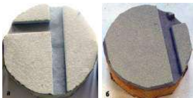
Рис. 3. Внешний вид фасадной пенополиуретановой термопанели с клинкерной плиткой производства фирмы «ADW Klinker» коллекции «Beige Rustic Besandet» (x3): а) до воздействия УФ излучения; б) после воздействия УФ излучения (607 часов 30 минут)
