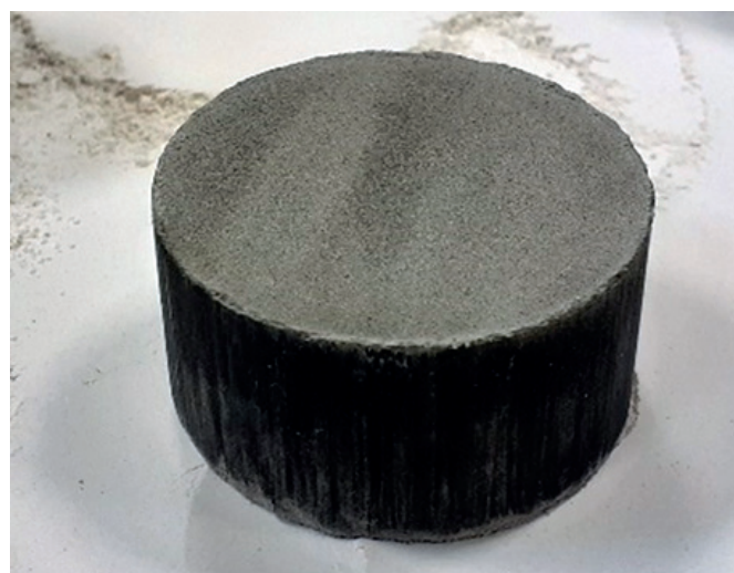
Рис. 1. Образец пеностекла, подготовленные к тепловой обработке. Фото авторов статьи
