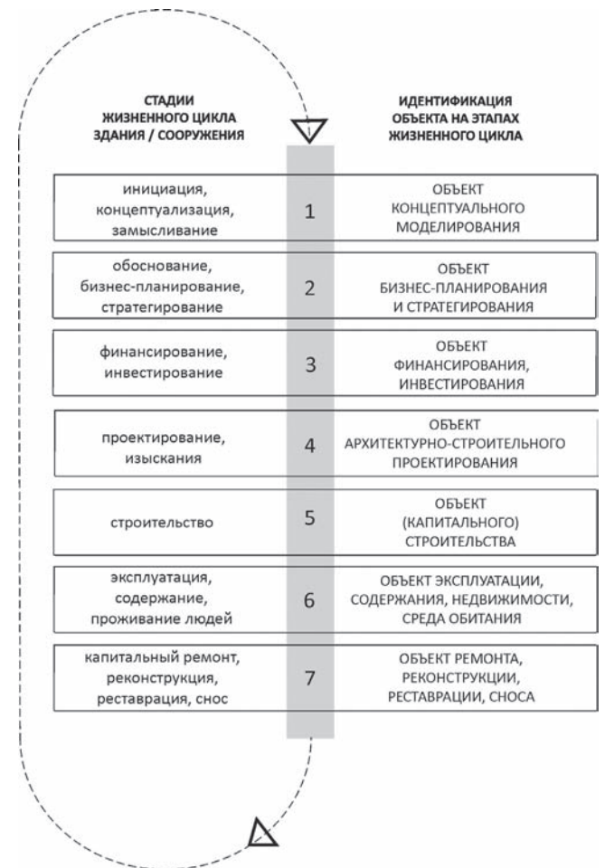
Рис. 1. Совокупность объектов в структуре жизненного цикла здания. Схема автора статьи
