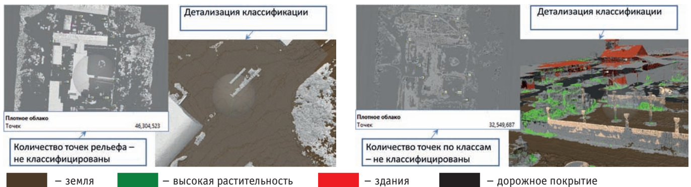
Рис. 3. Результат анализа работы алгоритма классификации: а) рельеф; б) по классам
