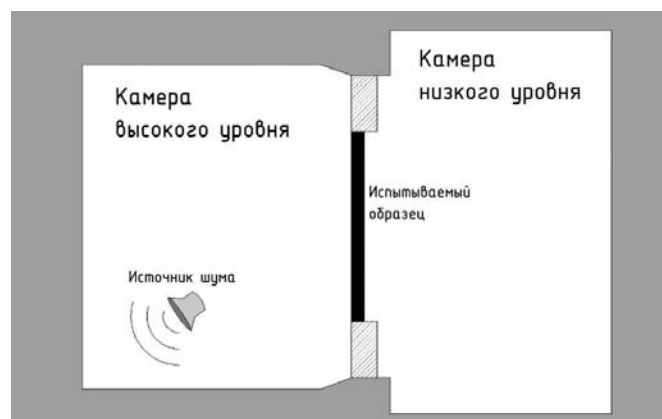
Рис. 3. Схема реверберационной акустической камеры
