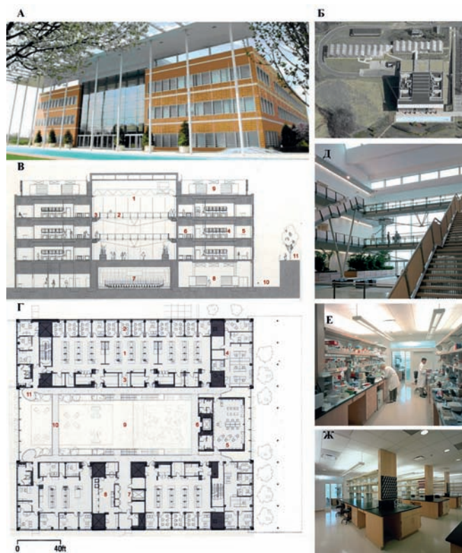
Рис. 6. Научный инкубатор «Центр Дональда Дэнфорда»: А – южный фасад; Б – вид комплекса сверху; В – поперечный разрез: (1 – многосветный атриум; 2 – пешеходный мостик; 3 – пешеходная галерея; 4 – экспериментальные лаборатории; 5 – теоретические лаборатории, офисы; 6 – вспомогательные помещения; 7 – аудитория; 8, 9 – инженерно-технические службы; 10 – служебная зона; 11 – автостоянки); Г – план 2-го и 3-го этажей (1 – экспериментальные лаборатории; 2 – теоретические лаборатории, офисы; 3 – вспомогательные помещения; 4 – административные помещения; 5 – библиотека; 6, 7 – лифты; 8 – мини-кухня; 9 – многосветный атриум; 10 – пешеходный мостик; 11 – зона встреч, контактов и отдыха); Д – многосветный атриум; Е, Ж – лабораторные помещения
