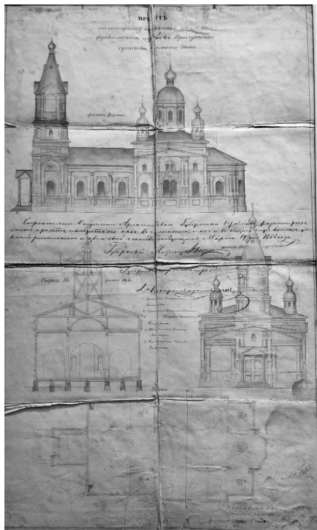
Рис. 5. Проект на постройку деревянной на каменном фундаменте церкви Прилуцкого прихода Онежского уезда. 1866 год (источник: МБУК «Онежский историко-мемориальный музей». № КП-6711)
