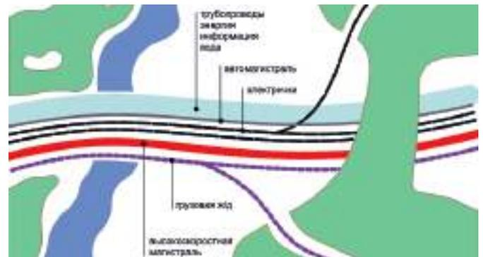
Рис. 7. По новому Транссибу скоростные поезда должны идти по эстакадам. Промышленные перевозки должны иметь свои железнодорожные пути. Кроме людей и грузов, вдоль Транссиба могут двигаться потоки воды, энергии, полезных ископаемых и информации. Вдоль Транссиба также, должны пойти скоростные автомобильные дороги. В результате, Транссиб станет по современной международной терминологии «транспортным коридором»
