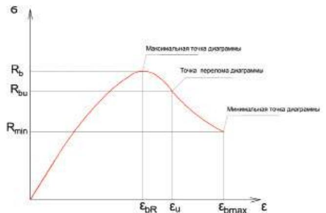
Рис. 2. Основные параметрические точки диаграммы деформирования « $\sigma$ – $\varepsilon$ » бетона при сжатии
