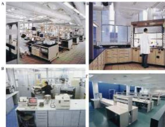
Рис. 16. В рамках «концепции общих лабораторий» персоналу предоставляется совместимый набор рабочих мест со взаимозаменяемым лабораторным и вспомогательным оборудованием. В дальнейшем при трансформации пространства рабочие места могут быть гибко заменены или расширены. Лаборатории: А, Б – химические, В – универсальная междисциплинарная, Г – медицинская
