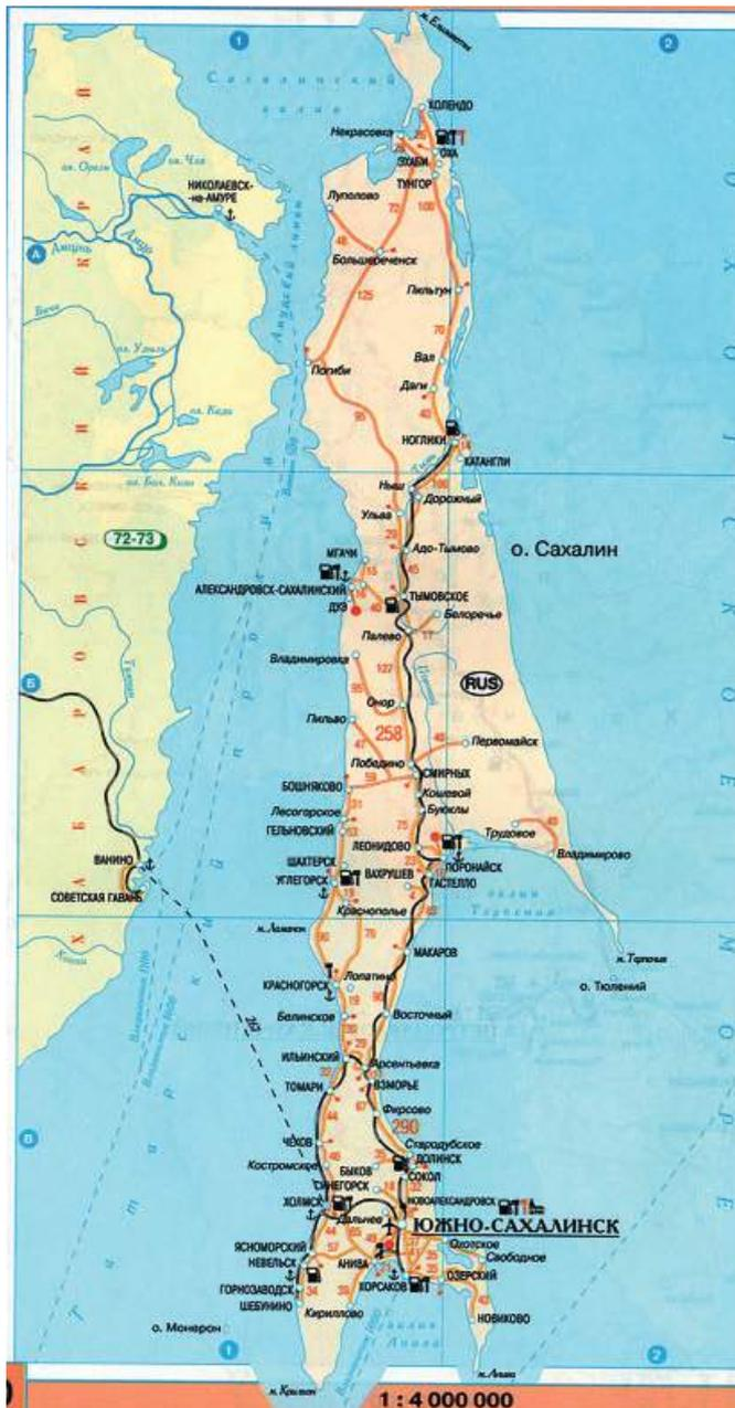
Рис. 11. Трансиб приходит на Дальний Восток к острову Сахалин. На Сахалине есть своя железная дорога, она связывает порт Ноглики с Южно-Сахалинском и портом Корсаков на юге. Предполагается продлить железные дороги на север острова двумя ветками. Западная ветка дойдёт до Погиби и через тоннель соединится с материком.
