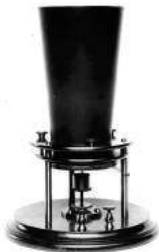
Рис. 1. Жидкостной преобразователь А. Белла
