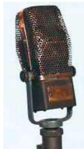
Рис. 3. Ленточный микрофон RCA 44А
