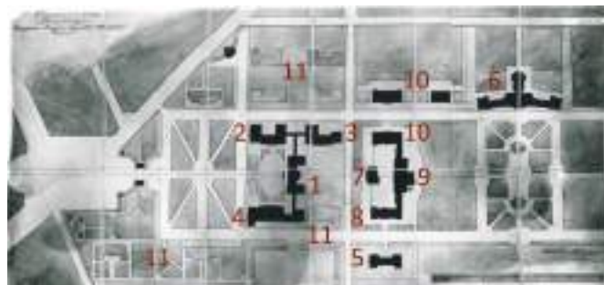
Рис. 10. Итоговый проект. Генеральный план больничного городка: 1) центральный корпус; 2) хирургический павильон; 3) терапевтический павильон; 4) павильон для выздоравливающих; 5) заразный корпус; 6) санаторий для туберкулёзных; 7) кухня; 8) прачечная и баня; 9) центральная станция; 10) дома для персонала; 11) будущее расширение. 1913 год [8, л. 33]
