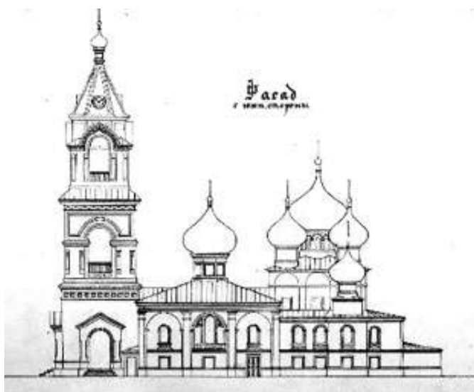
Рис. 6. Село Пурех. Фиксационные чертежи Преображенской церкви XVII века. 1926 год. Южный фасад, планы нижнего и верхнего этажей [8]
