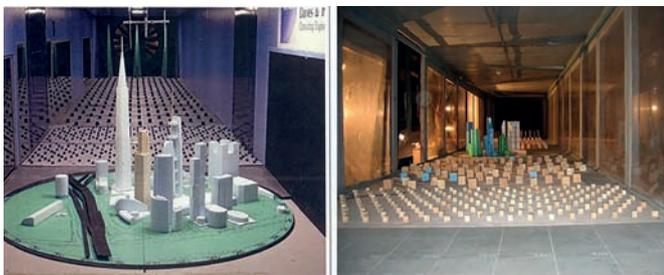
Рис. 1. Макет комплекса ММДЦ «Москва-Сити» в аэродинамической трубе
