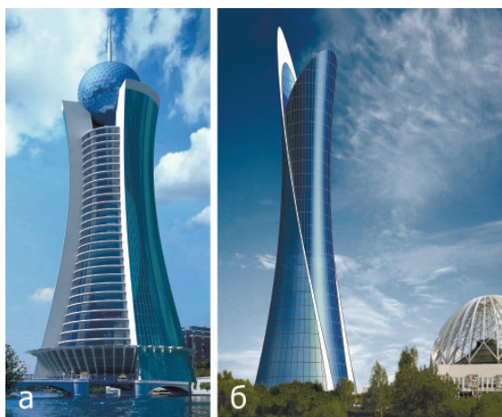
Рис. 16. Отсечение фрагментов поверхностей многослойной исходной гиперboloидной модели, образованной соосными подобными гиперboloидными объёмами, вставленными друг в друга. Разработки и рисунки А.В. Коротича
