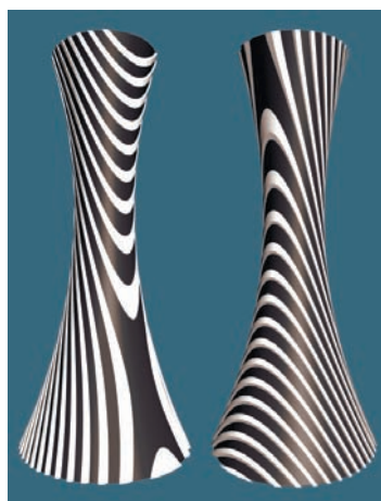
Рис. 17. Отсечение фрагментов поверхностей многослойной исходной гиперboloидной модели, образованной соосными подобными гиперboloидными объёмами, вставленными друг в друга. Разновидность способа. Разработка и рисунок А.В. Коротича
