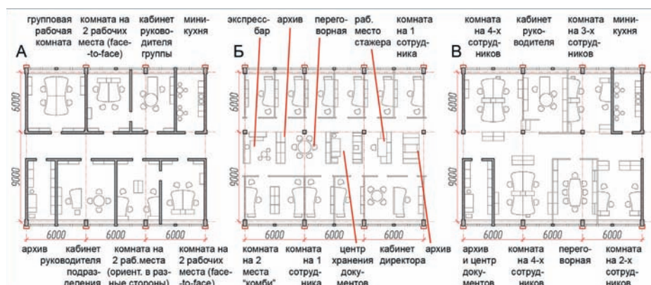
Рис. 3. Решение теоретических лабораторий и офисных помещений на основе модульной сетки (источник: [5]). Типы планировки: А – кабинетная с внутренним коридором; Б – смешанная (кабинетная+ландшафтная); В – групповые офисы
