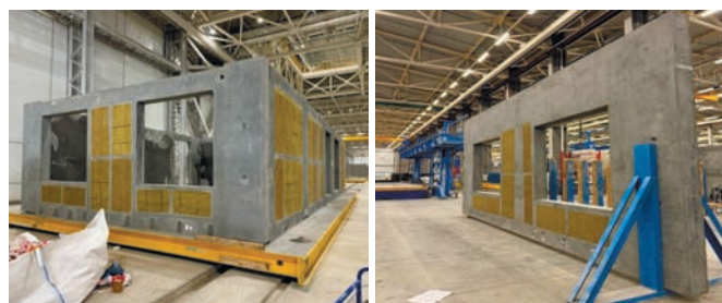
Рис. 6. Готовые изделия из лёгкого бетона класса В65 \gamma = 1850-1950 \text{ кг/м}^3
