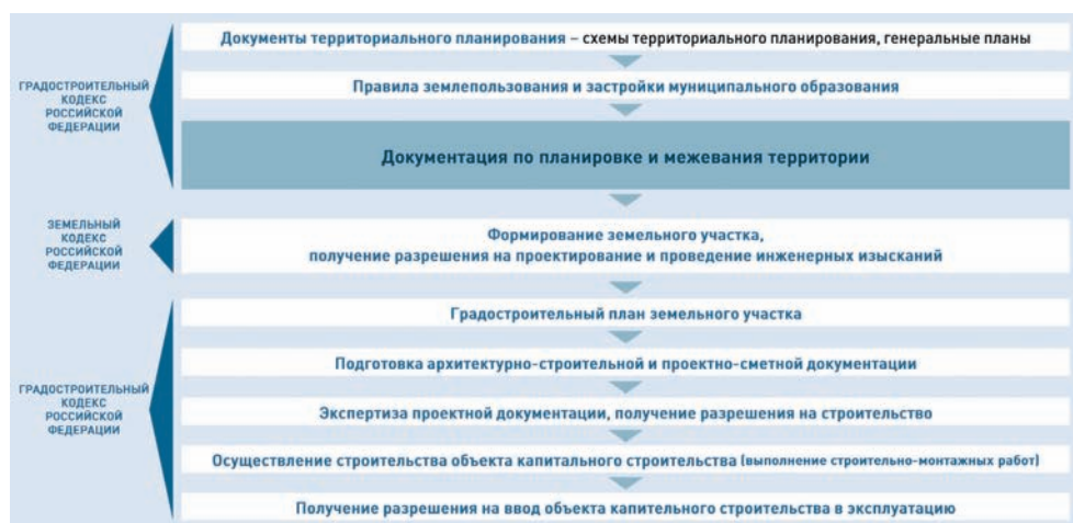
Рис. 5. Порядок осуществления строительства объектов
