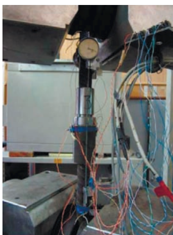
Рис. 10. Характер разрушения контрольного образца МСА А500С Ø36 мм с использованием позиционной муфты CONCON с конической резьбой при динамическом растяжении
