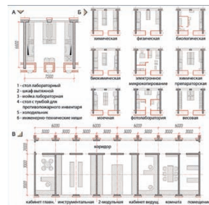
Рис. 4. Решение лабораторий общенаучного профиля на основе модульной сетки (источник: [7]): А – помещение на 4 рабочих места; Б – лаборатории различного профиля; В – пример компоновки помещений в составе лабораторного блока
