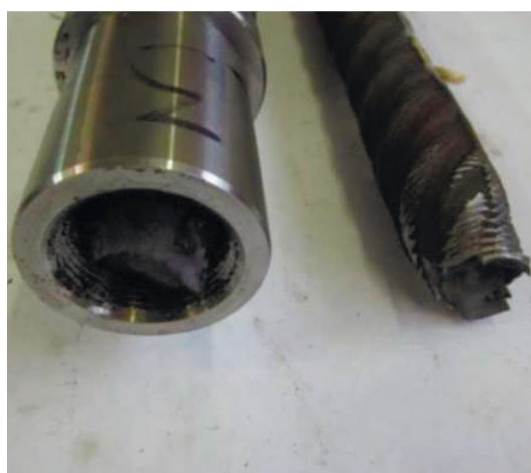
Рис. 10. Характер разрушения контрольного образца МСА А500С Ø36 мм с использованием позиционной муфты CONCON с конической резьбой при динамическом растяжении
