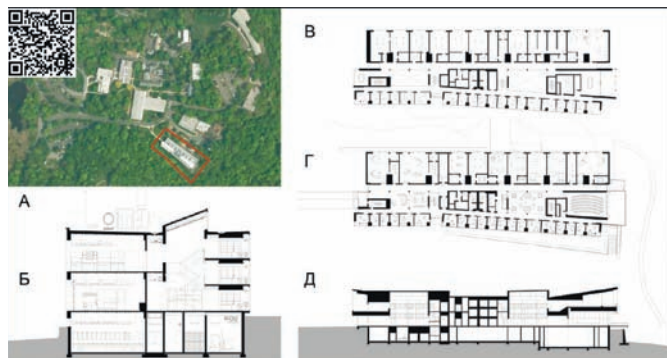
Рис. 8. Научный центр геохимии имени Гэри К. Комера: А – аэрофотосъёмка; Б – поперечный разрез; В – план третьего этажа; Г – план первого этажа; Д – продольный разрез по линейному общественному пространству с атриумами
