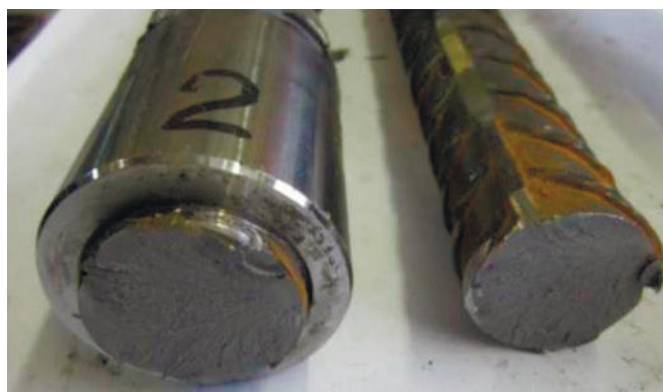
Рис. 4. Хрупкий характер разрушения МСА Dextra BF с параллельной резьбой (производитель 2) с некорректным режимом утолщения концов соединяемых стержней методом «холодного» продольного прессования при динамическом нагружении, мм
