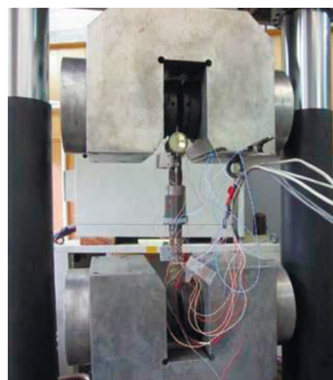
Рис. 2. Экспериментальная оценка деформативности равнопрочных МСА
